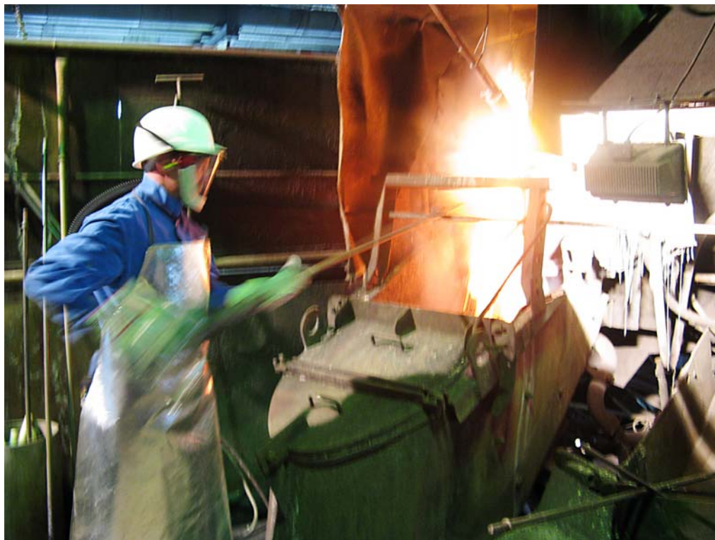
Ein Mitarbeiter der Weser-Metall misst die Temperatur am Schlackenstich des Badschmelzofens. (Bild: Weser-Metall GmbH)
