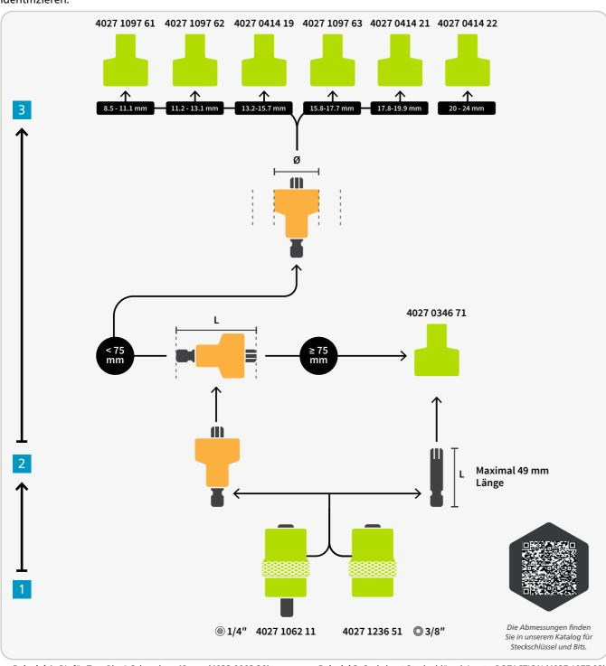
Beispiel 1: Bit für Torx Plus®-Schrauben 49 mm (4023 0002 20).
