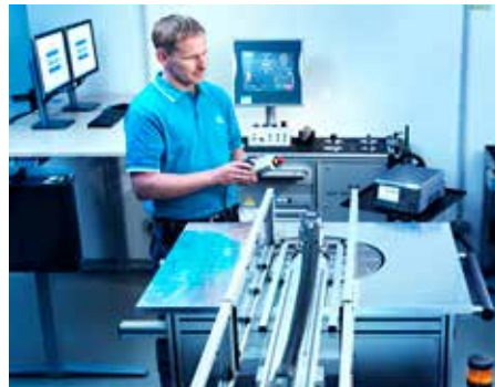
Durchführung einer DKD-Kalibrierung von Messgeräten
