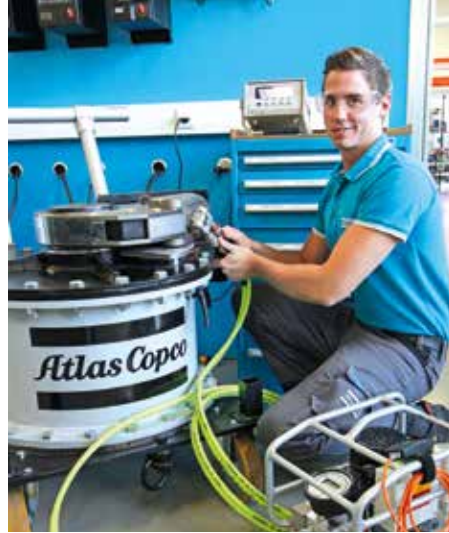
Hydraulischer Drehmomentschlüssel (links) und Kalibrierung eines solchen Werkzeugs (vorne im Bild ist die Hydraulikpumpe zu sehen).
