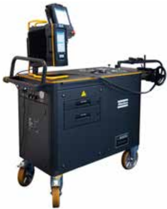
Die Maschinenfähigkeit von Schraubwerkzeugen muss regelmäßig auf rückführbar kalibrierten Messeinrichtungen, wie dieser Messbank, überprüft werden.
