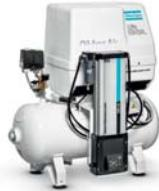
**LFD:** одноступенчатый безмасляный поршневой компрессор со встроенными осушителями; максимальное рабочее давление – 10 бар (145 фунт/дюйм<sup>2</sup>).
