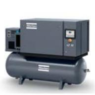
**LZ:** одноступенчатый безмасляный поршневой компрессор с глушителем, автоматическое управление или управление контроллером Elektronikon® Mk5; максимальное рабочее давление – 10 бар (145 фунт/дюйм<sup>2</sup>).
