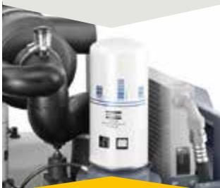
Закручиваемый сепаратор с хорошим доступом
