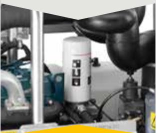
Закручиваемый фильтр компрессорного масла с хорошим доступом
