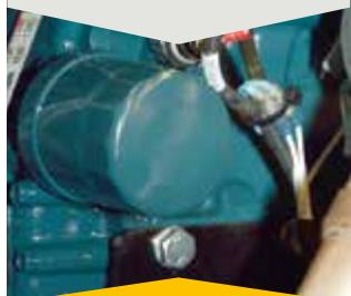
Закручиваемый фильтр моторного масла с хорошим доступом
