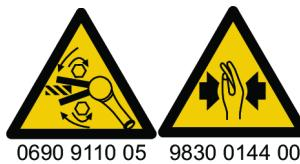
Prije početka rada provjerite smjer okretanja alata! Pokretanje u neočekivanom smjeru okretanja može prouzročiti tjelesnu ozljedu ili imovinsku štetu. Pokretni dijelovi mogu zdrobiti i preseći.
