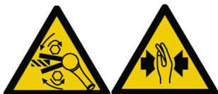
Kontrollér værktøjets rotationsretning før start! Start i en uventet rotationsretning kan forårsage læsioner eller beskadigelse af ejendom. Bevægelige dele kan knuse og skære.
