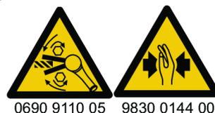
Inspeccione a direção de rotação da ferramenta antes de começar! Ligar a ferramenta em uma direção de rotação inesperada pode provocar acidentes ou danos materiais. Peças em movimento podem provocar esmagamento e cortes.
