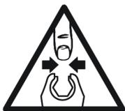
Om du använder en främre del med öppen ände tillsammans med detta verktyg kan det leda till att fingrar och händer kläms.
