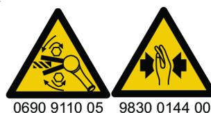
Przed uruchomieniem narzędzia należy sprawdzić kierunek jego obrotów! Uruchomienie narzędzia w nieoczekiwanym kierunku może spowodować obrażenia ciała lub szkody materialne. Ruchome części mogą spowodować zmiążdżenia i skaleczenia.
