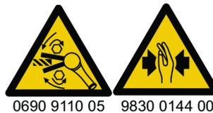
Gör en kontroll av verktygets rotationsriktning före start! En start i en oväntad rotationsriktning kan orsaka kroppsskada eller egendomsskada. Rörliga delar kan krossa och skära.
