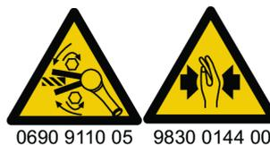
Pred spustením vykonajte kontrolu smeru otáčania nástroja! Spustenie v neočakávanom smere otáčania môže spôsobiť telesné zranenie alebo poškodenie majetku. Pohyblivé diely môžu spôsobiť pomliaždenie a porezanie.
