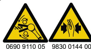
Procéder à un contrôle du sens de rotation de l'outil avant de démarrer ! Un démarrage dans un sens de rotation inattendu peut provoquer des accidents corporels ou des dégâts matériels. Les pièces mobiles peuvent broyer et couper.
