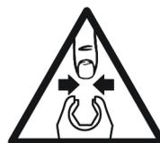
Użycie otwartej części przedniej z tym narzędziem może spowodować zmiążdżenie palców i dłoni.
