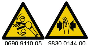
Antes de comenzar a trabajar, compruebe la dirección de giro de la herramienta. Si se desconoce la dirección de giro pueden provocarse lesiones personales o daños materiales. Las partes móviles pueden aplastar y cortar.
