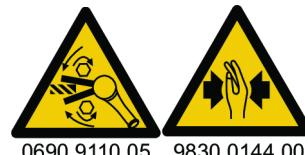
Eseguire un controllo della direzione di rotazione dell'utensile prima dell'avvio! Un avvio in una direzione di rotazione imprevista può causare lesioni o danni. Le parti mobili possono schiacciare e tagliare.
