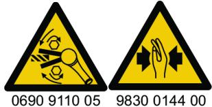
Vor dem Start die Drehrichtung des Werkzeugs prüfen. Ein Start in eine unerwartete Drehrichtung kann zu Verletzungen und Sachschäden führen. Bewegliche Teile stellen eine Quetsch- und Schnittgefahr dar.
