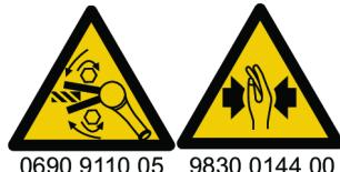
Procéder à un contrôle du sens de rotation de l'outil avant de démarrer ! Un démarrage dans un sens de rotation inattendu peut provoquer des accidents corporels ou des dégâts matériels. Les pièces mobiles peuvent broyer et couper.
