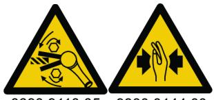
Před spuštěním zkонтrolujte směr otáčení nástroje! Spuštění nástroje s neočekávaným směrem otáčení může mít za následek úraz nebo škodu na majetku. Pohyblivé části mohou drtit a řezat.
