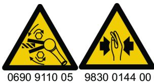
Gör en kontroll av verktygets rotationsriktning före start! En start i en oväntad rotationsriktning kan orsaka kroppsskada eller egendomsskada. Rörliga delar kan krossa och skära.
