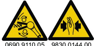
Inspecione a direção de rotação da ferramenta antes de começar! Ligar a ferramenta em uma direção de rotação inesperada pode provocar acidentes ou danos materiais. Peças em movimento podem provocar esmagamento e cortes.
