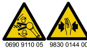
Ellenőrizze a szerszám forgási irányát, mielőtt elindítaná! A szerszámgép hirtelen elindulása a nem várt forgási irányban súlyos személyi sérülést és a tulajdon károsodását okozhatja. A mozgó alkatrészek zúzódásos és vágásos sérüléseket okozhatnak.
