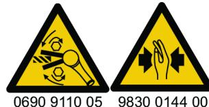
Prije početka rada provjerite smjer okretanja alata! Pokretanje u neočekivanom smjeru okretanja može prouzročiti tjelesnu ozljedu ili imovinsku štetu. Pokretni dijelovi mogu zdrobiti i preseći.
