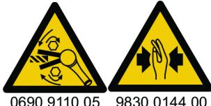
Gör en kontroll av verktygets rotationsriktning före start! En start i en oväntad rotationsriktning kan orsaka kroppsskada eller egendomsskada. Rörliga delar kan krossa och skära.
