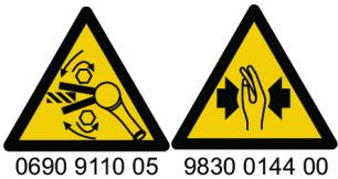
Przed uruchomieniem narzędzia należy sprawdzić kierunek jego obrotów! Uruchomienie narzędzia w nieoczekiwany kierunku może spowodować obrażenia ciała lub szkody materialne. Ruchome części mogą spowodować zmiażdżenia i skałeczenia.
