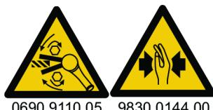
Před spuštěním zkонтrolujte směr otáčení nástroje! Spuštění nástroje s neočekávaným směrem otáčení může mít za následek úraz nebo škodu na majetku. Pohyblivé části mohou drtit a řezat.
