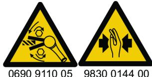
Foreta en kontroll av rotasjonsretningen til verktøyet før start! En start i en uventet rotasjonsretning kan forårsake personskade eller materielle skader. Bevegelige deler kan knuse og kutte.
