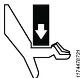
Pred spustením vykonajte kontrolu smeru otáčania nástroja! Spustenie v neočakávanom smere otáčania môže spôsobiť telesné zranenie alebo poškodenie majetku
