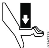
Ellenőrizze a szerszám forgási irányát, mielőtt elindítaná! A szerszámgép hirtelen elindulása a nem várt forgási irányban súlyos személyi sérülést és a tulajdon károsodását okozhatja
