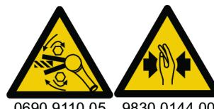
Foreta en kontroll av rotasjonsretningen til verktøyet før start! En start i en uventet rotasjonsretning kan forårsake personskade eller materielle skader. Bevegelige deler kan knuse og kutte.
