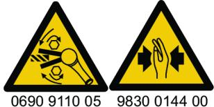
始動前に回転方向を確認してください！予期しない回転方向に動き出すと、負傷や物的損害が発生するおそれがあります。可動部品によって押しつぶされ切斷されるおそれがあります。
