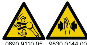
Ellenőrizze a szerszám forgási irányát, mielőtt elindítaná! A szerszámgyép hirtelen elindulása a nem várt forgási irányban súlyos személyi sérülést és a tulajdon károsodását okozhatja. A mozgó alkatrészek zúzódásos és vágásos sérüléseket okozhatnak.
