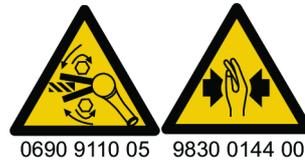
Inspeção a direção de rotação da ferramenta antes de começar! Ligar a ferramenta em uma direção de rotação inesperada pode provocar acidentes ou danos materiais. Peças em movimento podem provocar esmagamento e cortes.
