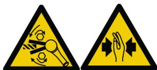
Ellenőrizze a szerszám forgási irányát, mielőtt elindítaná! A szerszám hirtelen elindulása a nem várt forgási irányban súlyos személyi sérülést és a tulajdon károsodását okozhatja. A mozgó alkatrészek zúzódásos és vágásos sérüléseket okozhatnak.
