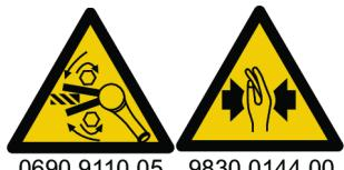
Ellenőrizze a szerszám forgási irányát, mielőtt elindítaná! A szerszámép hirtelen elindulása a nem várt forgási irányban súlyos személyi sérülést és a tulajdon károsodását okozhatja. A mozgó alkatrészek zúzódásos és vágásos sérüléseket okozhatnak.
