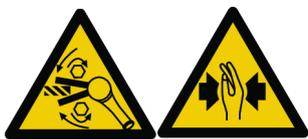
Przed uruchomieniem narzędzia należy sprawdzić kierunek jego obrotów! Uruchomienie narzędzia w nieoczekiwanym kierunku może spowodować obrażenia ciała lub szkody materialne. Ruchome części mogą spowodować zmiążdżenia i skaleczenia.
