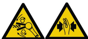
Inspecione a direção de rotação da ferramenta antes de começar! Ligar a ferramenta em uma direção de rotação inesperada pode provocar acidentes ou danos materiais. Peças em movimento podem provocar esmagamento e cortes.
