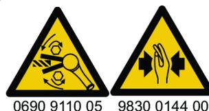
Ellenőrizze a szerszám forgási irányát, mielőtt elindítaná! A szerszámgép hirtelen elindulása a nem várt forgási irányban súlyos személyi sérülés és a tulajdon károsodását okozhatja. A mozgó alkatrészek zúzódásos és vágásos sérüléseket okozhatnak.
