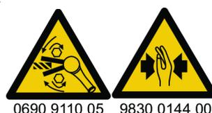
Перед началом работы проверьте направление вращения инструмента! Запуск с неправильным направлением вращения может привести к травмам или материальному ущербу. Движущиеся части могут раздавить или порезать.
