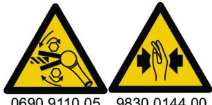
始動前に回転方向を確認してください！予期しない回転方向に動き出すと、負傷や物的損害が発生するおそれがあります。可動部品によって押しつぶされて切斷されるおそれがあります。
