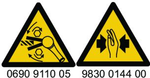
Przed uruchomieniem narzędzia należy sprawdzić kierunek jego obrotów! Uruchomienie narzędzia w nieoczekiwany kierunku może spowodować obrażenia ciała lub szkody materialne. Ruchome części mogą spowodować zmiażdżenia i skażenia.
