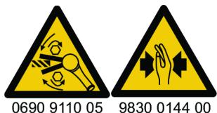
Antes de comenzar a trabajar, compruebe la dirección de giro de la herramienta. Si se desconoce la dirección de giro pueden provocarse lesiones personales o daños materiales. Las partes móviles pueden aplastar y cortar.
