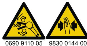
Inspecione a direção de rotação da ferramenta antes de começar! Ligar a ferramenta em uma direção de rotação inesperada pode provocar acidentes ou danos materiais. Peças em movimento podem provocar esmagamento e cortes.
