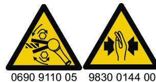
Ellenőrizze a szerszám forgási irányát, mielőtt elindítaná! A szerszámép hirtelen elindulása a nem várt forgási irányban súlyos személyi sérülést és a tulajdon károsodását okozhatja. A mozgó alkatrészek zúzódásos és vágásos sérüléseket okozhatnak.
