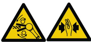
Pred spustením vykonajte kontrolu smeru otáčania nástroja! Spustenie v neočakávanom smere otáčania môže spôsobiť telesné zranenie alebo poškodenie majetku. Pohyblivé diely môžu spôsobiť pomliaždenie a porezanie.
