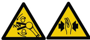
Eseguire un controllo della direzione di rotazione dell'utensile prima dell'avvio! Un avvio in una direzione di rotazione imprevista può causare lesioni o danni. Le parti mobili possono schiacciare e tagliare.
