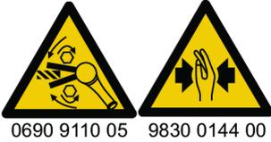
Başlamadan önce aletin dönüş yönünü kontrol edin! Beklenmedik bir dönüş yönünde başlangıç bedensel yaralanmaya veya maddi zarara neden olabilir. Hareketli parçalar ezilme ve kesilmeye neden olabilir.
