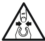
Nikad ne posežite rukom u unutrašnjost glave ključa. Pokretni dijelovi mogu zdrobiti i preseći. Držite ruke i prste daleko od pokretnih dijelova.
