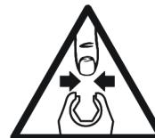
Greifen Sie niemals in das offene Ende des Schlüssels. Bewegliche Teile stellen eine Quetsch- und Schnittgefahr dar. Halten Sie Hände und Finger von beweglichen Teilen fern.
