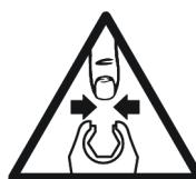
Ne mettez jamais vos doigts dans la tête de l'extrémité ouverte. Les pièces mobiles peuvent broyer et couper. Garder les mains et les doigts loin des pièces mobiles.
