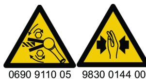
Przed uruchomieniem narzędzia należy sprawdzić kierunek jego obrotów! Uruchomienie narzędzia w nieoczekiwany kierunku może spowodować obrażenia ciała lub szkody materialne. Ruchome części mogą spowodować zmiażdżenia i skaleczenia.
