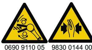
在开始前务必检查工具转动方向！在意外转动方向下启动可能会造成严重的人身伤害或财产损失。活动部件可能导致压伤和割伤。
